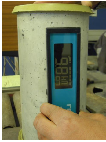
Resistividad Eléctrica SR
